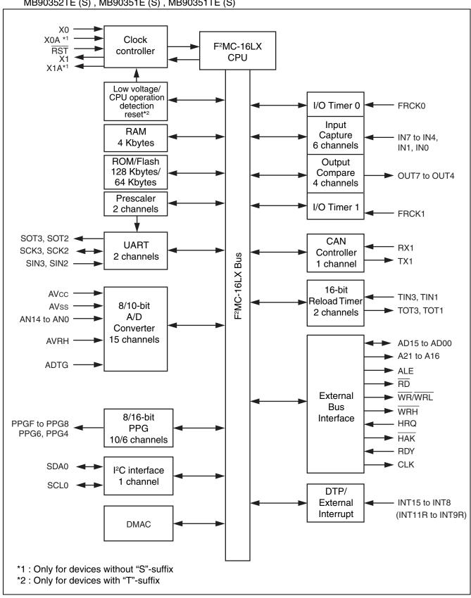
MB90F357E (S), MB90F357TE (S), MB90F356E (S), MB90F356TE (S), MB90357E (S), MB90357TE (S),
